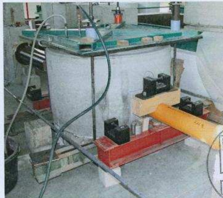
Bild 4: Dichtheitsprüfung bei Eintragung einer Scherlast am PP-Rohr
