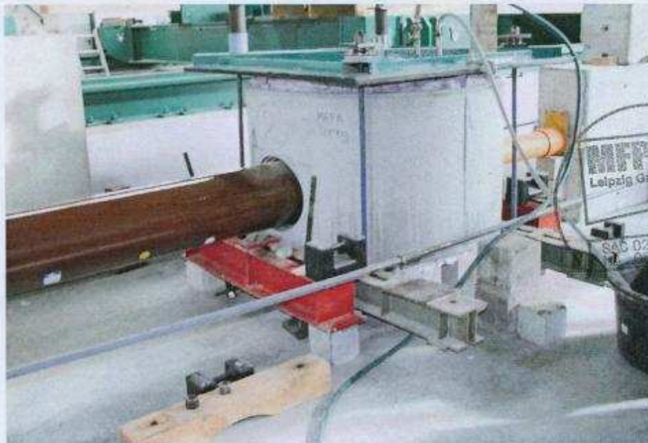
Bild 6: Dichtheitsprüfung bei 1,0 bar ohne mechanische Beanspruchung nach Abschluss der Scherlasteintragung
