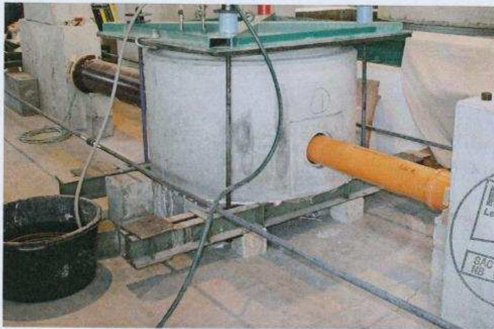
Bild 1: Ansicht Schachtunterteil mit Schachtfutter und montiertem PP-Rohr DN 150 sowie Steinzeugrohr DN 250 bei der Prüfung der Wasserdichtheit ohne mechanische Beanspruchung der Anschlussrohre
