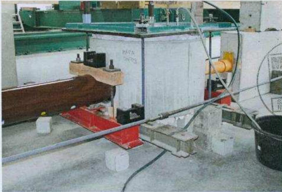
Bild 5: Dichtheitsprüfung nach drei Monaten Scherlasteintragung, durchgeführt mit 0,5 bar und 1,0 bar
